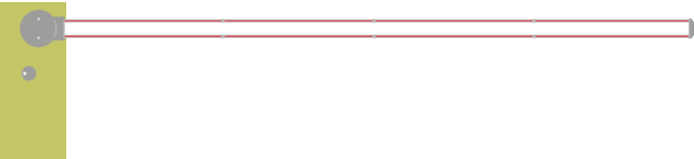
OPEN 6000 + ASO 5000 Barreira com acessórios de fixação e comprimento máximo da haste 5 m
